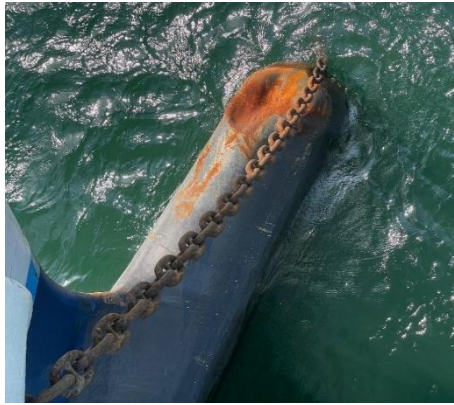
Gambar 5. Kerusakan Bulbous Bow .
